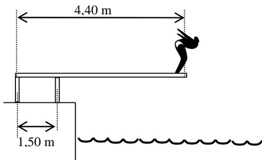
**5. (Resnick Cap 9 E 28)** Um mergulhador com 780 N de peso está sobre a extremidade de uma prancha de saltos uniforme que tem comprimento de 4,40 m e peso 145 N. A prancha está fixa por dois pedestais separados de 1,50 m segundo a figura ao lado. Encontre a tração ou compressão em cada um dos pedestais.
