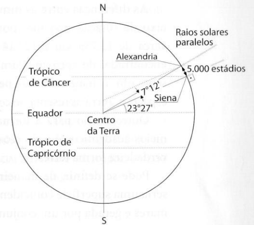
Fig. 1.1 Esquema do método utilizado por Eratóstenes para o cálculo da circunferência da Terra
