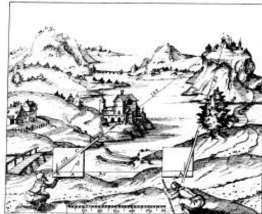
Figura 2.3 - A Prancheta foi divulgada numa publicação Alemã de 1614, "Novum Instrumentum Geometricum", por Leonhard Zubler (Na prática usava-a horizontalmente para medir distâncias, mas não alturas.)
