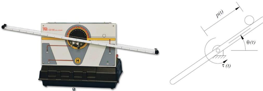
**Figura 1 – Foto e esquema do sistema Ball and Beam**
