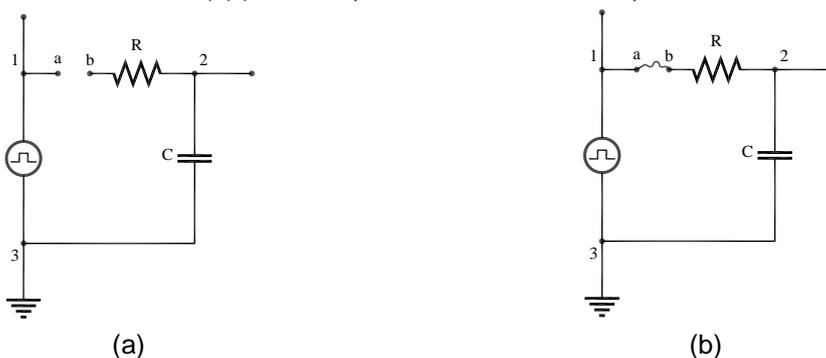
**Pontos a e b conectados por um fio**(Fig.4.7(b)): Notem que o sinal varia um pouco quando o circuito é ligado, ou seja, conectando os pontos a e b com um fio. O que está ocorrendo?
