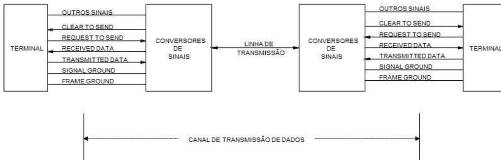
**Figura 1 – Interligação entre dois Terminais de Dados.**
