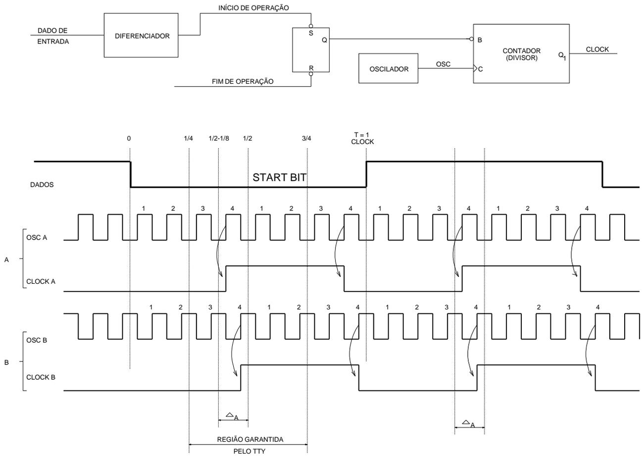
Figura 6 – Circuito de Recepção: Diagrama de blocos e Diagrama de sinais.
