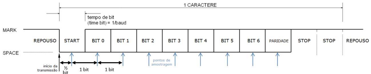
**Figura 5 – Ilustração dos pontos de amostragem dos bits.**
