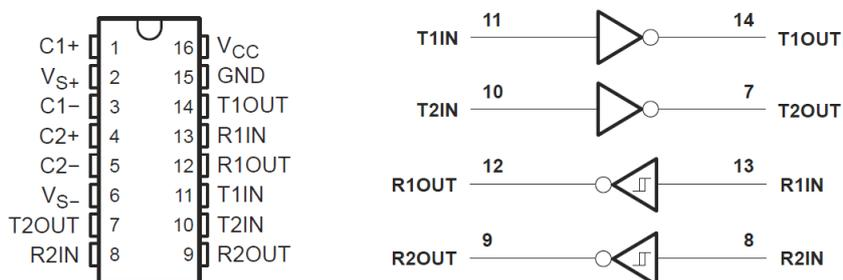
**Figura 8 – Pinagem e esquema lógico do MAX232.**
