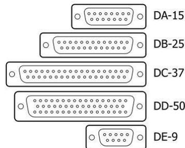
**Figura 2 – Alguns conectores – interface mecânica.**
