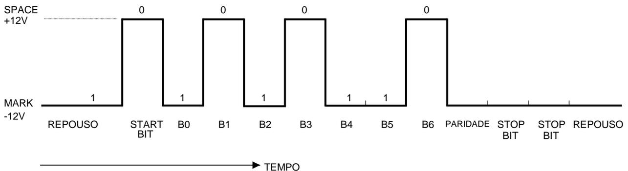
**Figura 4 – Formato da saída serial da palavra  $(0110101)_2$ .**
