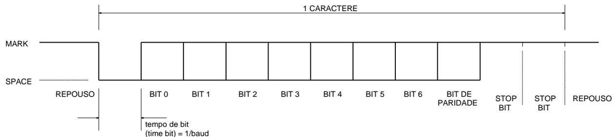
**Figura 3 – Protocolo Serial Assíncrono (MARK e SPACE).**
