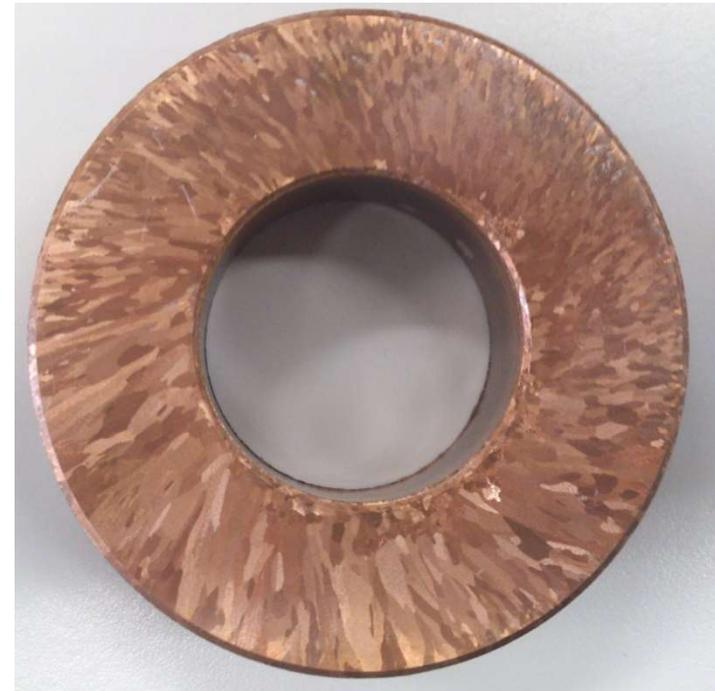
**Tubo de cobre fundido continuamente**
