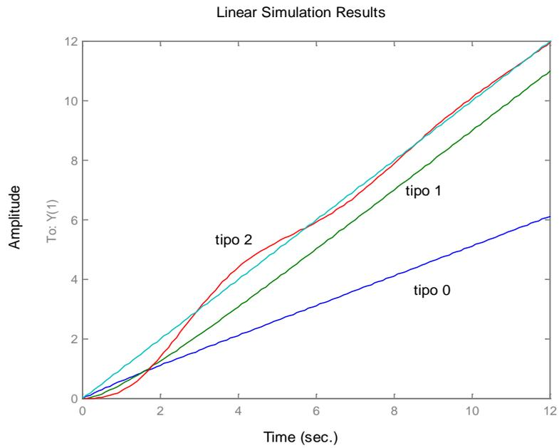
Fig. 10.2 Respostas dos sistemas tipo 0, 1 e 2 em malha fechada com entrada rampa
