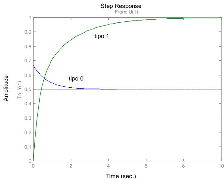
Fig. 10.1 Respostas dos sistemas tipo 0 e 1 em malha fechada com entrada degrau unitário
