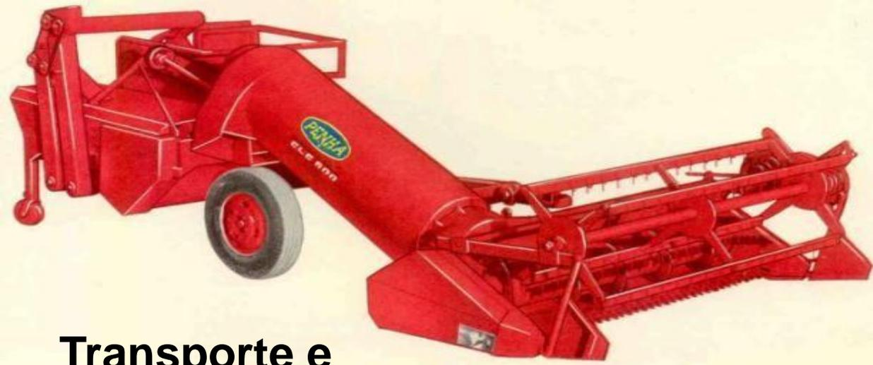
Colhedora combinada de grãos semi-montada com plataforma segadora e acionada pela TDP
