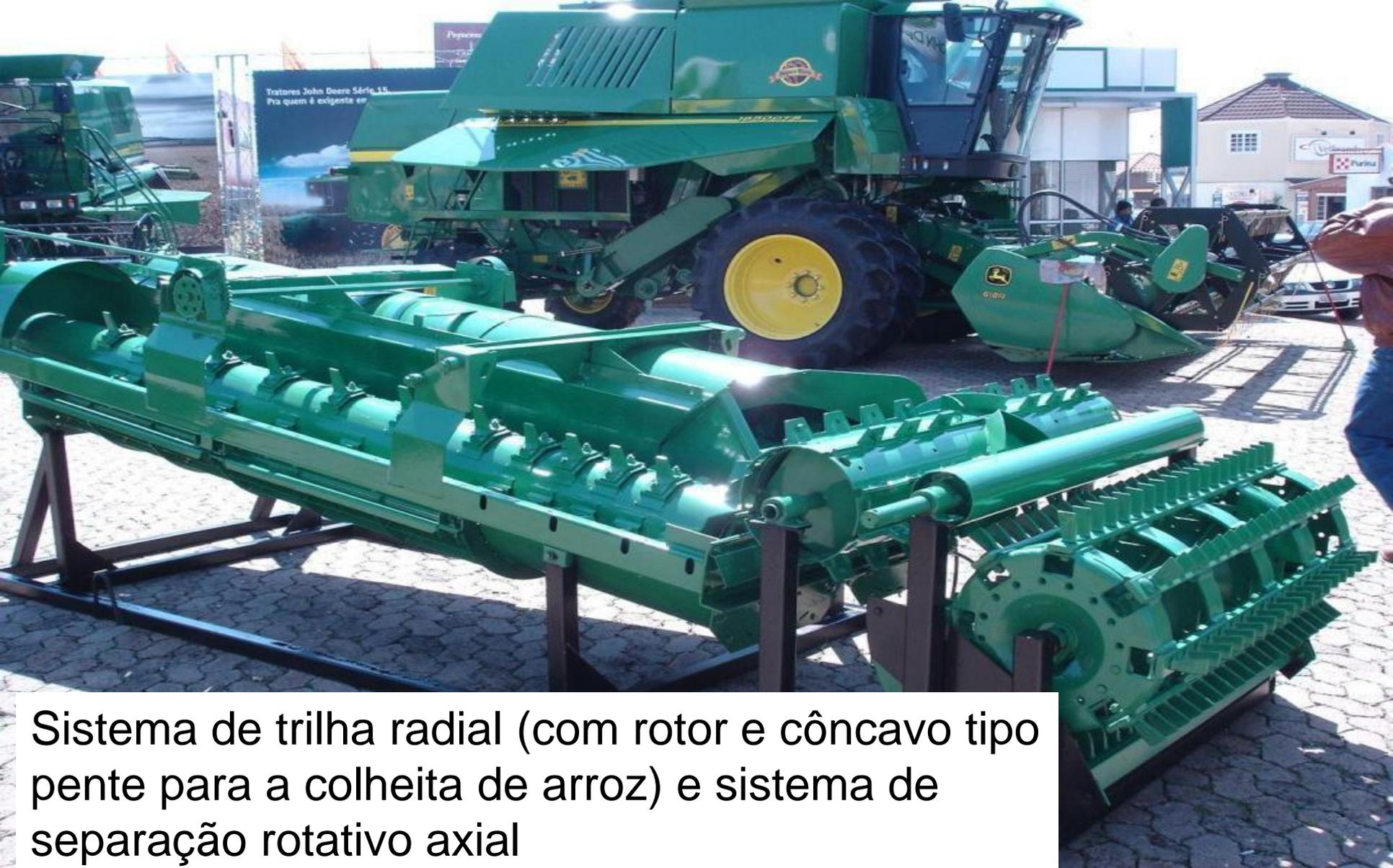
Sistema de trilha radial (com rotor e cônica tipo pente para a colheita de arroz) e sistema de separação rotativo axial
