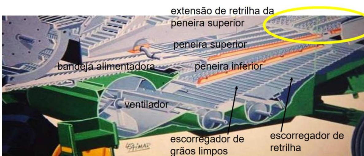
Figura 11. Sistema de limpeza com a bandeja de alimentação, as duas peneiras, ventilador e a extensão de retilha da peneira superior
