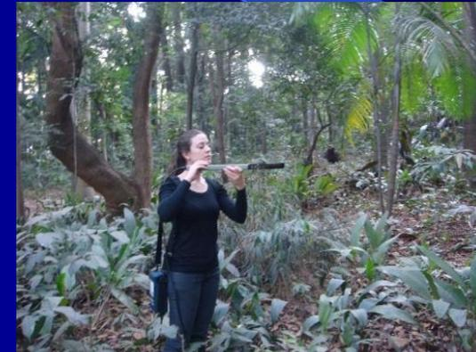
equipamento que calcula o LAI pelas medidas de radiação feitas com um sensor ótico acoplado a uma lente grande angular
