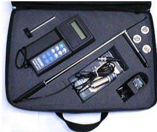
Figura 1.6.15: Termoanemômetro (temperatura do ar e velocidade do ar)
