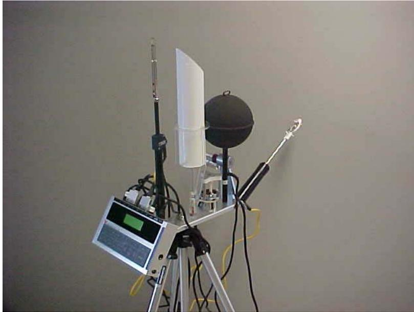
Figura 1.6.16: Equipamento para medição de conforto e estresse BABUC – Itália
