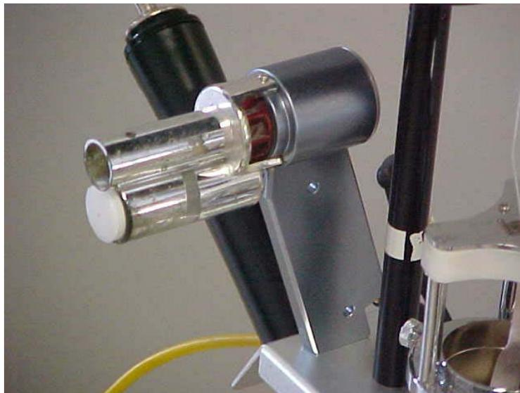
Figura 1.6.19: Psicrômetro com ventilação forçada, BABUC
