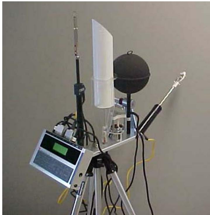
Fig 1: Confortímetro - BABUC
