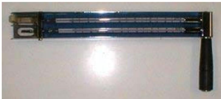
Figura 1.6.13: Psicrômetro giratório – Temperatura de bulbo seco (ar) e Temperatura de bulbo úmido com ventilação
