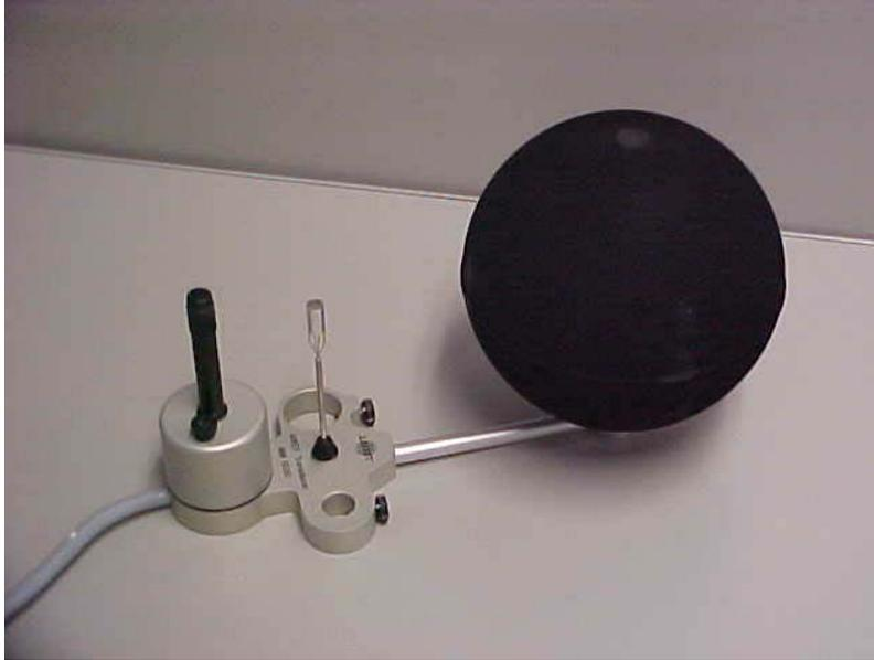
Figura 1.6.18: Equipamento para medição de IBUTG – B&K
