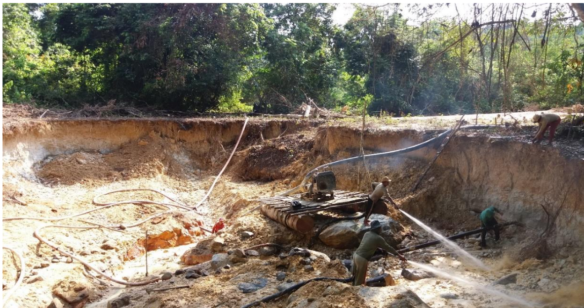
Figura 13 – Lavra por desmonte hidráulico de depósito de sedimentos não coesos em Peixoto de Azevedo (MT)
