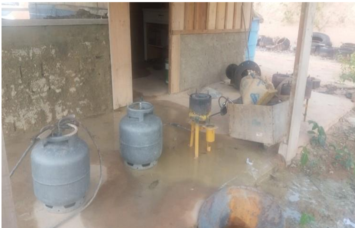
Figura 47 – Retorta para queima de amálgamas de mercúrio, Peixoto de Azevedo (MT)
