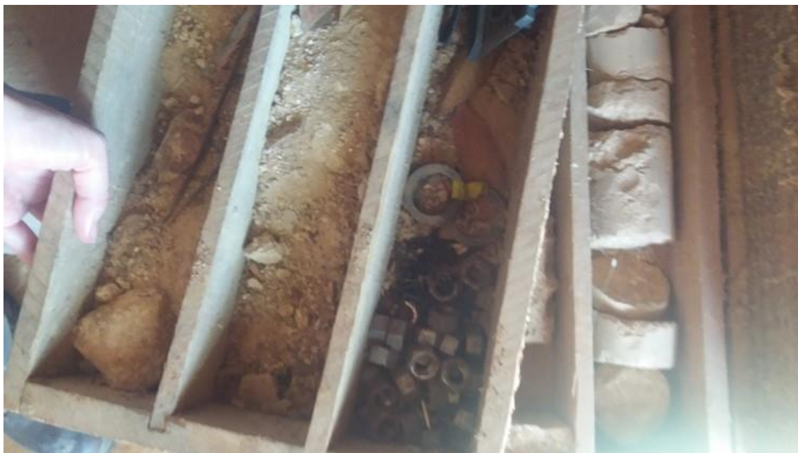
Figura 43 – Uso inadequado de caixa de testemunhos de sondagem, Guarantã do Norte (MT)
