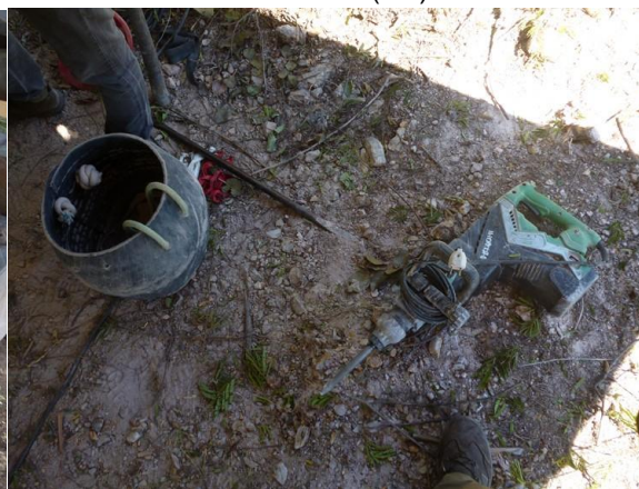
Figura 21 – Ferramentas básicas da mineração manual subterrânea em Novo Horizonte (BA)
