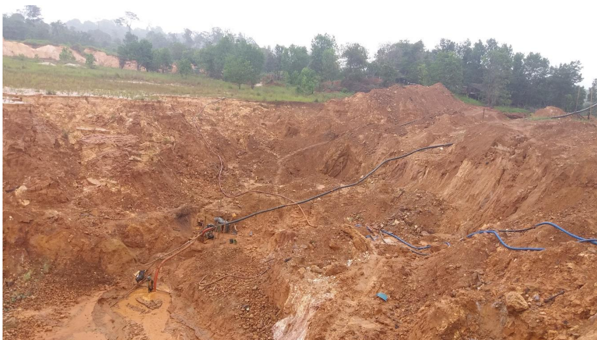
Figura 16 – Talude irregular, sem medidas de controle de estabilidade em Nossa Senhora do Livramento (MT)
