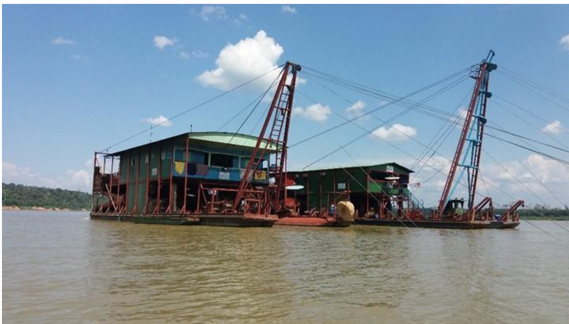
Figura 24 – Dragas em operação com flutuantes e estrutura em aço, Porto Velho (RO)
