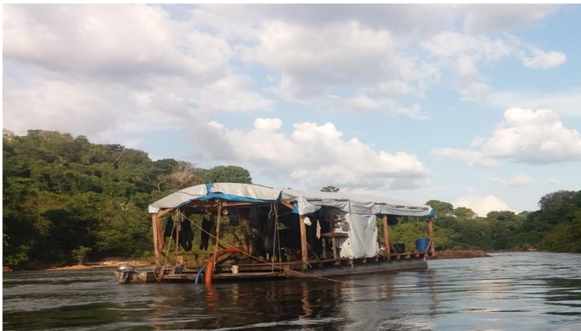
Figura 23 – Balsa em operação com flutuantes em aço e estrutura em madeira, Alta Floresta (MT)
