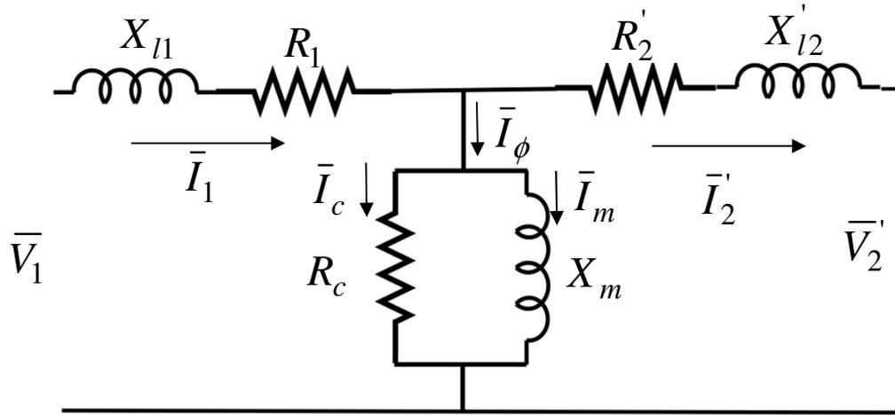
Os parâmetros do circuito equivalente podem ser determinados por meio de dois testes:
