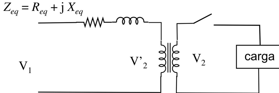
Além disso, para efeitos de análise e projeto, considera-se que a tensão sob carga  $V'_{2,\text{carga}}$  é igual à tensão nominal de placa do transformador (carga).
