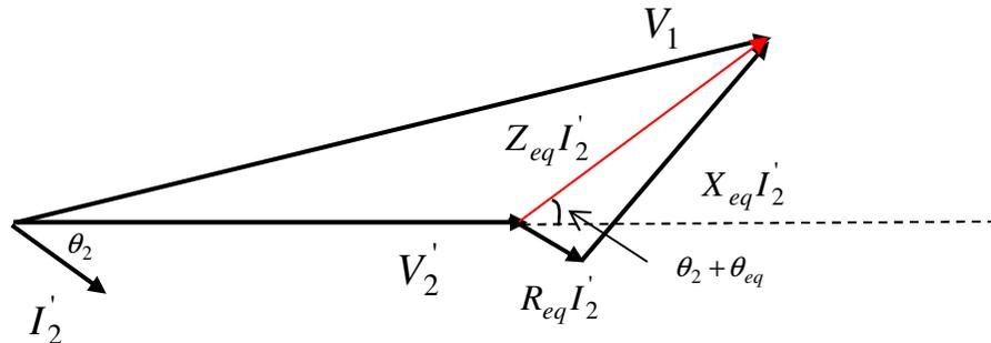
Obs:  $V_1$  deve ser ajustada em função da carga para que  $V_2$  sob carga opere no valor nominal (ou que  $V_2$  seja constante).
