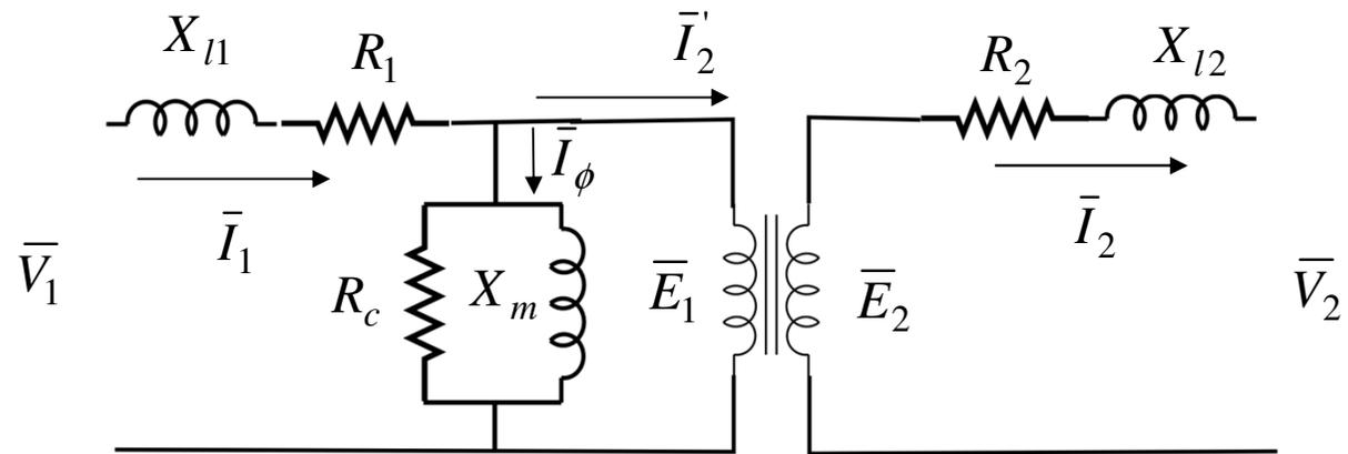
**Circuito equivalente de um transformador de dois enrolamentos**
