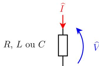
Figura 13: Bipolo elementar  $R$ ,  $L$  ou  $C$  na convenção do receptor.
