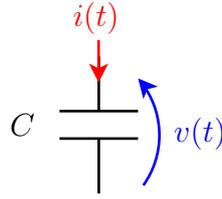
Figura 5: Capacitor ideal na convenção do receptor.
