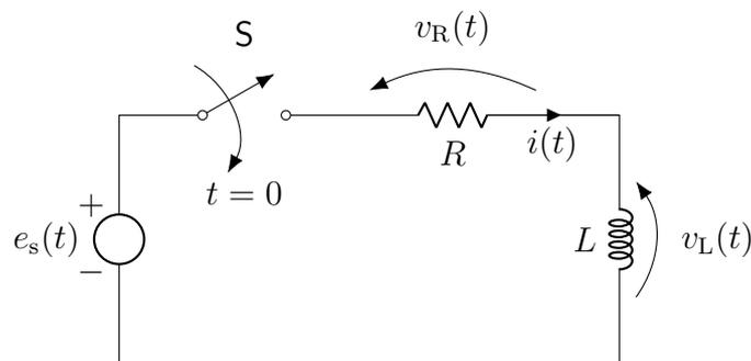
Figura 1: Circuito  $R, L$  série alimentado por um gerador ideal de tensão.
