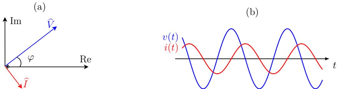
Figura 8: (a) Diagrama de fasores para  $\hat{V}$  e  $\hat{I}$  do indutor na convenção do receptor. (b) Formas de onda de  $v(t)$  e  $i(t)$  ao longo do tempo.
