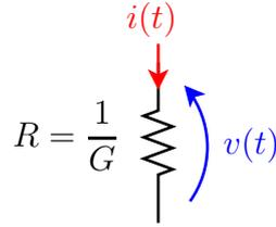
Figura 3: Resistor ideal na convenção do receptor.
