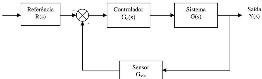
Fig. 5.1 Diagrama de bloco de um sistema de controle a malha fechada
