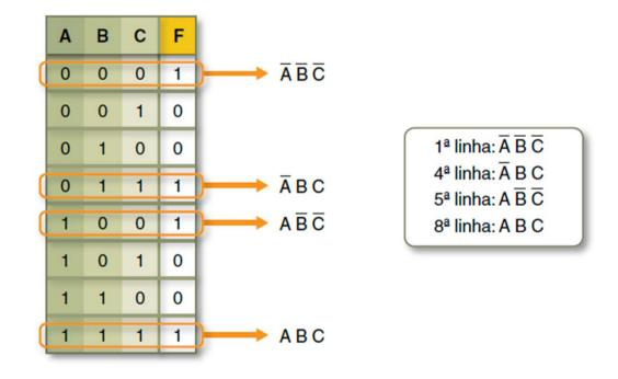
$$F = \overline{A}\overline{B}\overline{C} + \overline{A}BC + A\overline{B}\overline{C} + ABC$$
