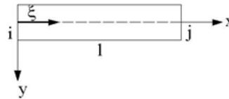
Fig. 2.1 (Elemento Finito de Viga)
