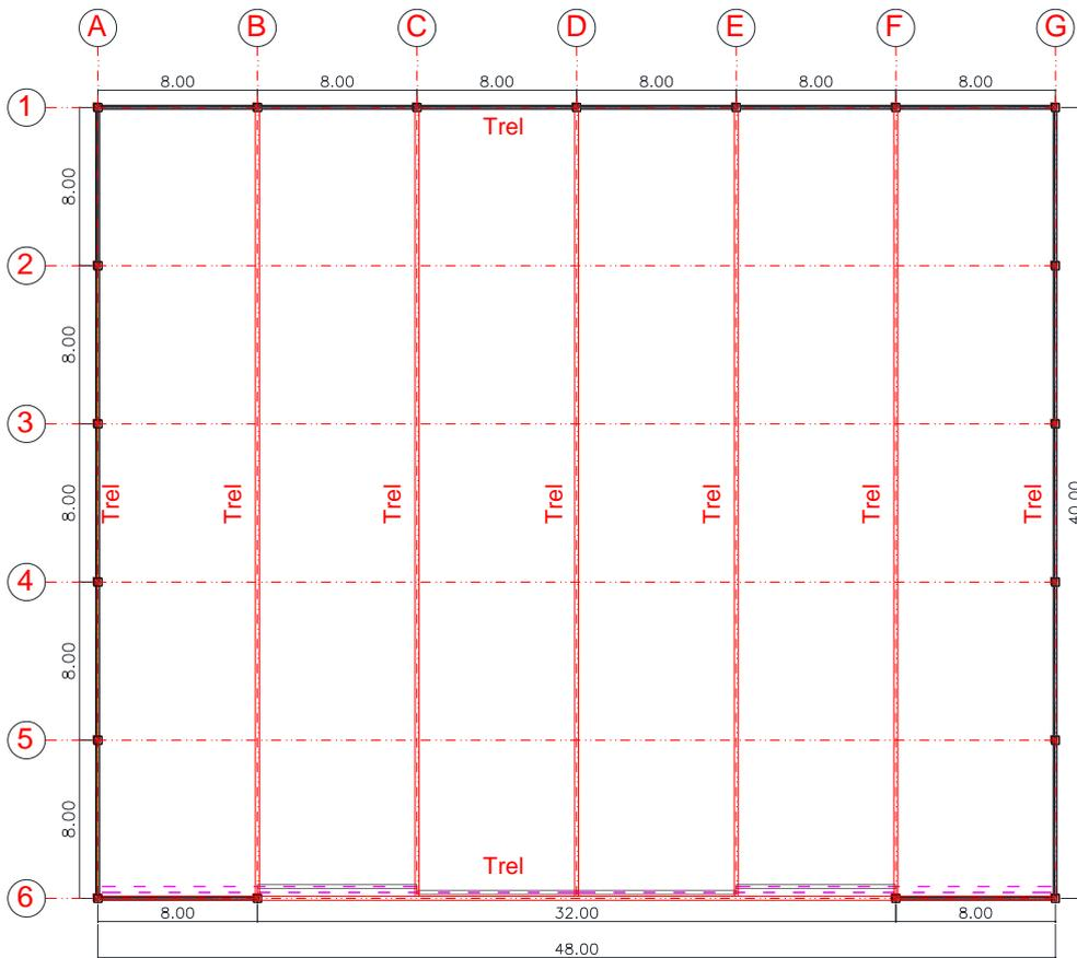
Planta 2 – Solução com orientação transversal das treliças de sustentação da cobertura (eixos A a G).
