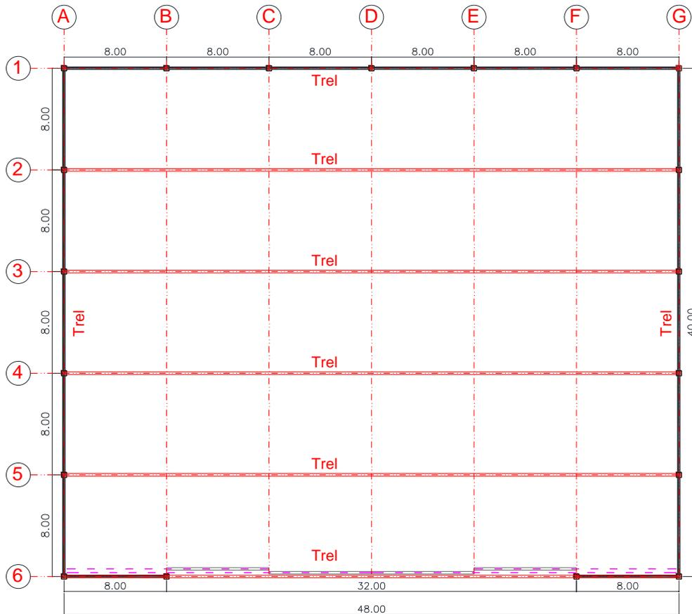
Planta 1 – Solução com orientação longitudinal das treliças de sustentação da cobertura (eixos 1 a 6).
