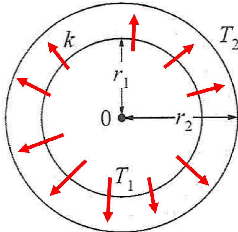
Condução de calor  $\left\{ \frac{dQ}{dt} = -k A \frac{dT}{dx} \right. \rightarrow \frac{dQ}{dt} = -k A \frac{dT}{dr}$
