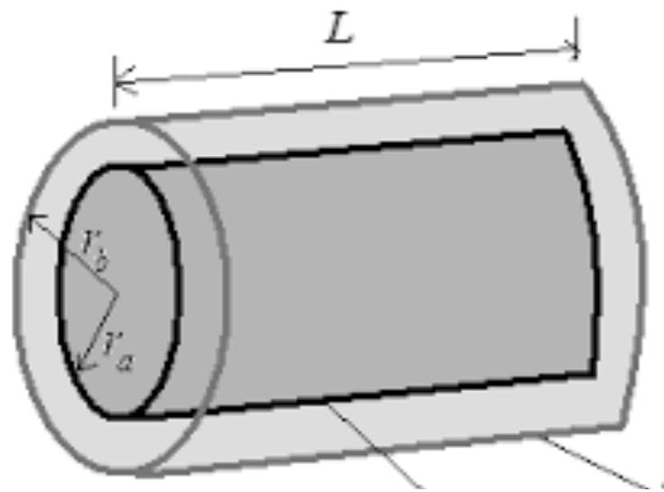
Condução de calor  $\left\{ \frac{dQ}{dt} = -k A \frac{dT}{dx} \right. \rightarrow \frac{dQ}{dt} = -k A \frac{dT}{dr}$
