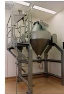
Aumento de rotação faz com que a força centrífuga prevaleça e quantidade de material fique aderido à parede do misturador.
