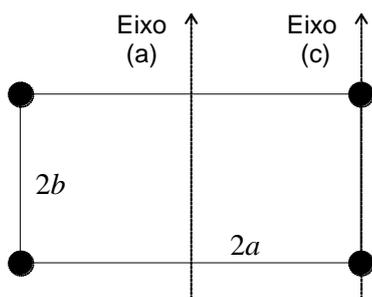
26. Quatro partículas de massa  $m$  estão fixas mediante hastes rígidas de massa desprezível, formando um retângulo de lados  $2a$  e  $2b$ , conforme mostra a figura ao lado. O sistema gira em torno de um eixo situado no plano da figura e que passa pelo centro.
