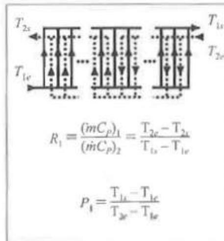
**Figura 10.15** Fator de correção da MLDT ( $F_{MLDT}$ ) para um trocador de calor de placas com arranjo de passes 1/2 ou 2/1 e entrada em cantos diametralmente opostos do pacote de placas. Como foi assumida a hipótese de número infinito de placas, o valor de  $n_{pl}$  pode ser par ou ímpar.
