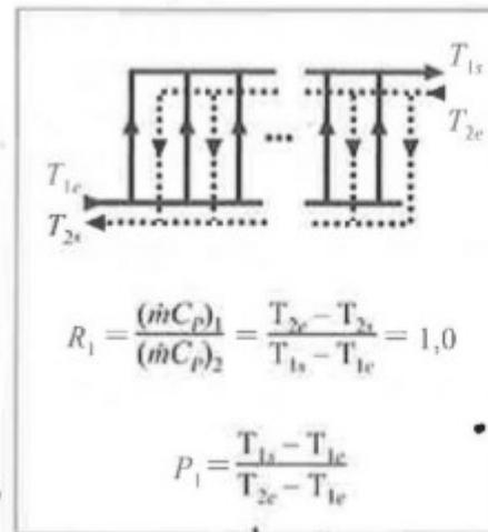
Figura 10.14 Fator de correção da MLDT ( $F_{MLDT}$ ) para um trocador de calor de placas contracorrente com arranjo de passes 1/1, número ímpar de placas térmicas e razão entre as capacidades térmicas  $R_1 = 1,0$ .
