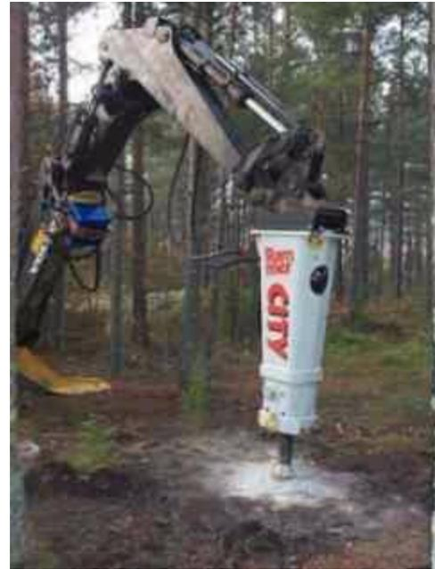
O método Mini-sosie foi desenvolvido por Barbier *et al.* (1976) e se utiliza de um sinal sísmico de baixa potência e longa duração.
