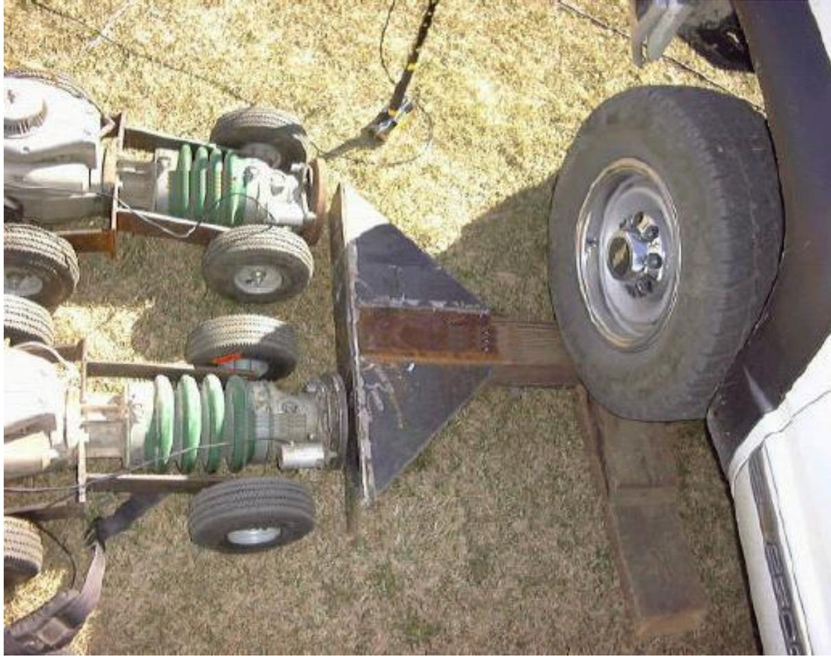
Rifle sísmico (fonte impulsiva explosiva) => onda P
