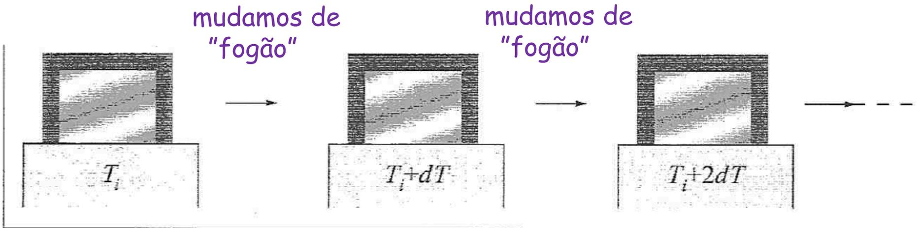
Figura 8.14 — Transferência reversível de calor
