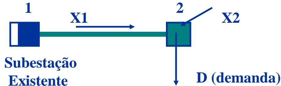
Deseja-se alimentar a carga em (2) com demanda  $D$ , através da instalação de um alimentador (1-2) e ampliação da Subestação 1 **ou** através da construção de uma nova Subestação em 2. Qual é a alternativa mais econômica? Sabe-se que os valores máximos de  $X1$  e  $X2$  são respectivamente  $XM1$  e  $XM2$  e que seus custos unitários (\$/MVA) são  $C1$  e  $C2$ , respectivamente.
