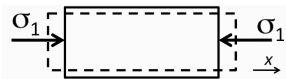
Fig. 3.2. Tensão uniaxial: p_{xx} = -\sigma_1 (compressão). p_{yy}=p_{zz}=0 ; p_{xy}=p_{xz}=p_{yz}=0 . A deformação \epsilon_{xx} = -\epsilon_1 da Fig. 3.1. Note que estamos adotando a convenção sismológica para o sinal das tensões.
