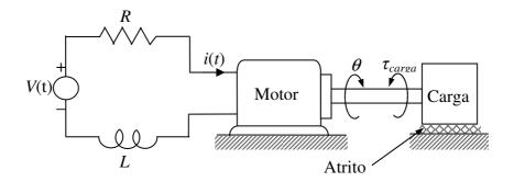
Assumindo que o eixo do motor é rígido e que existe atrito viscoso nos mancais do eixo, o modelo desse sistema é representado pelas seguintes equações diferenciais:
