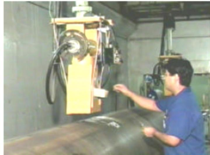
Inspeção radiográfica de soldas em tubos
