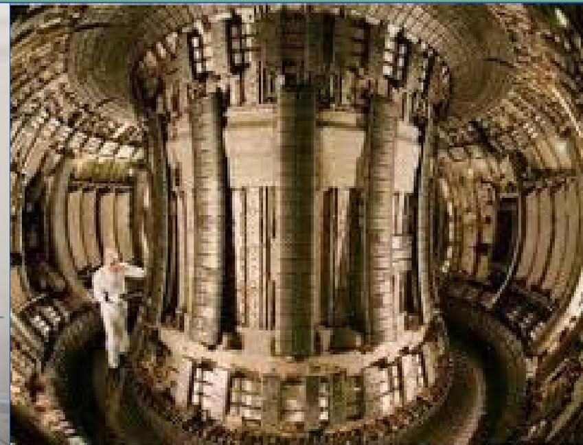
Figura 8 - Vista do interior de um Tokamak – o mais bem sucedido mecanismo para confinar plasma a altas temperaturas.
