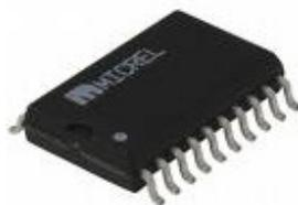
**Figura 5.6 Encapsulamento SOIC**
