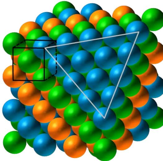
Sistema CFC mostrando a relação entre o sistema cúbico (destacado pelas linhas pretas) e o empilhamento compacto na direção [111], onde o plano (111) está destacado pelo triângulo cinza, após a remoção de um dos vértices da estrutura cúbica.
