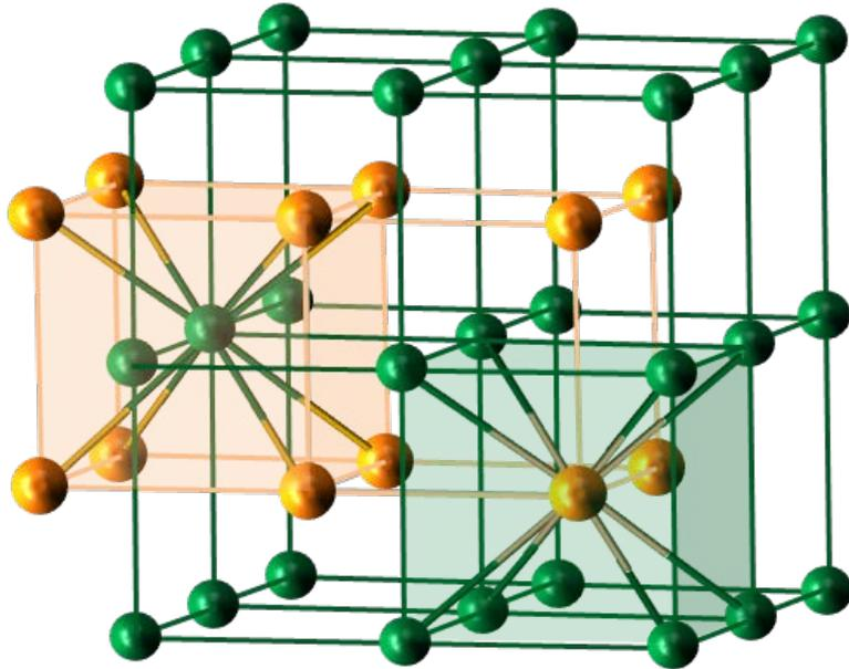
Cada átomo de uma espécie se encontra no centro de um cubo formado por átomos da espécie oposta. A estrutura cristalina do CsCl pode ser imaginada como duas redes CS, de parâmetro de rede  $a$ , deslocadas de metade da diagonal do cubo, cada uma delas com átomos de uma espécie em seus vértices.
