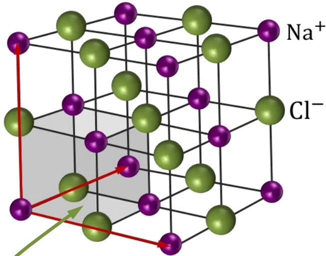
Esta estrutura pode ser imaginada como duas redes CFC, de parâmetro de rede  $a$ , deslocadas de metade da diagonal do cubo, cada uma delas com átomos de uma espécie em seus pontos de rede. A célula convencional CS possui 8 átomos na base.
