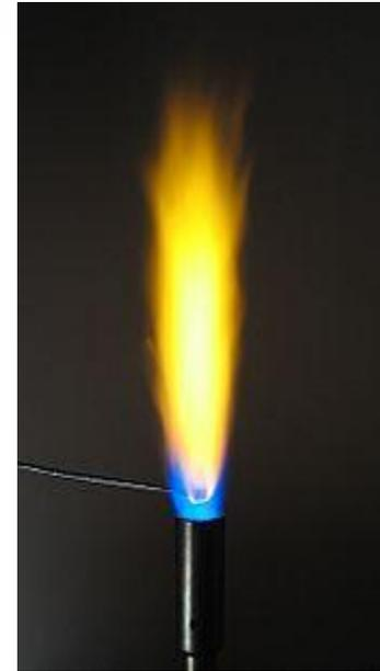
O Na é alcalino como o H. A linha amarela que ele emite é usada em lâmpadas. Seu espectro é relativamente simples comparado aos de outros elementos de massa próximas, não alcalinos.
