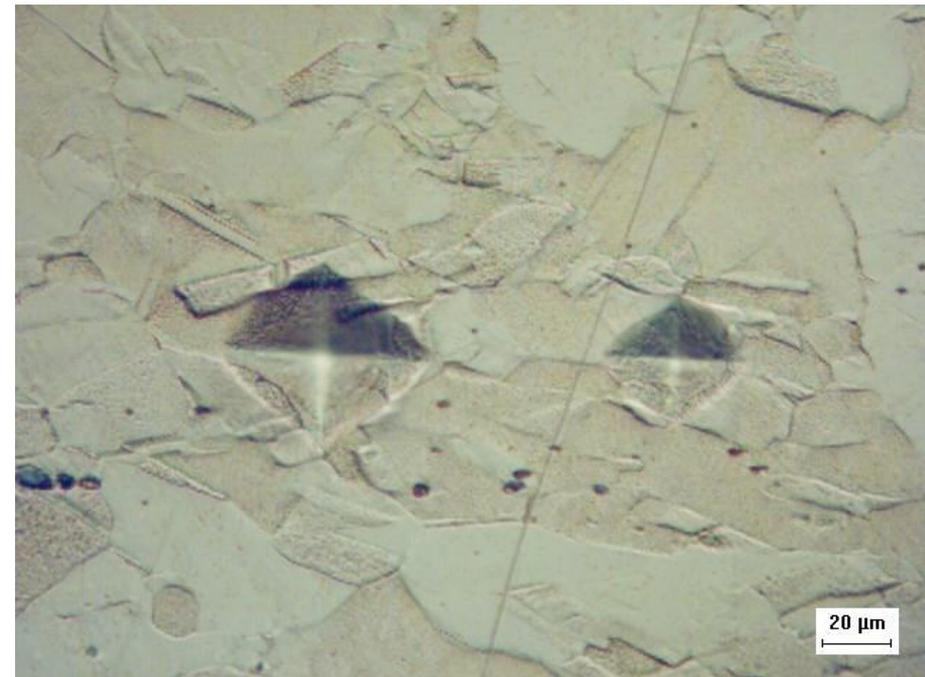
Amostra de Cobre eletrolítico endentado a) polido b) polido e atacado
