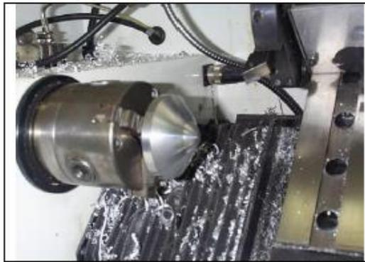
1 - A ferramenta utilizada para a pré-usinagem no CNC da DENFORD é de metal duro;
