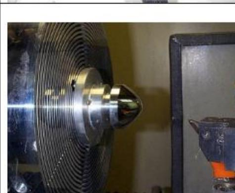
1 - A peça já pré-usinada é fixada ao suporte e este a placa do torno de ultraprecisão;
