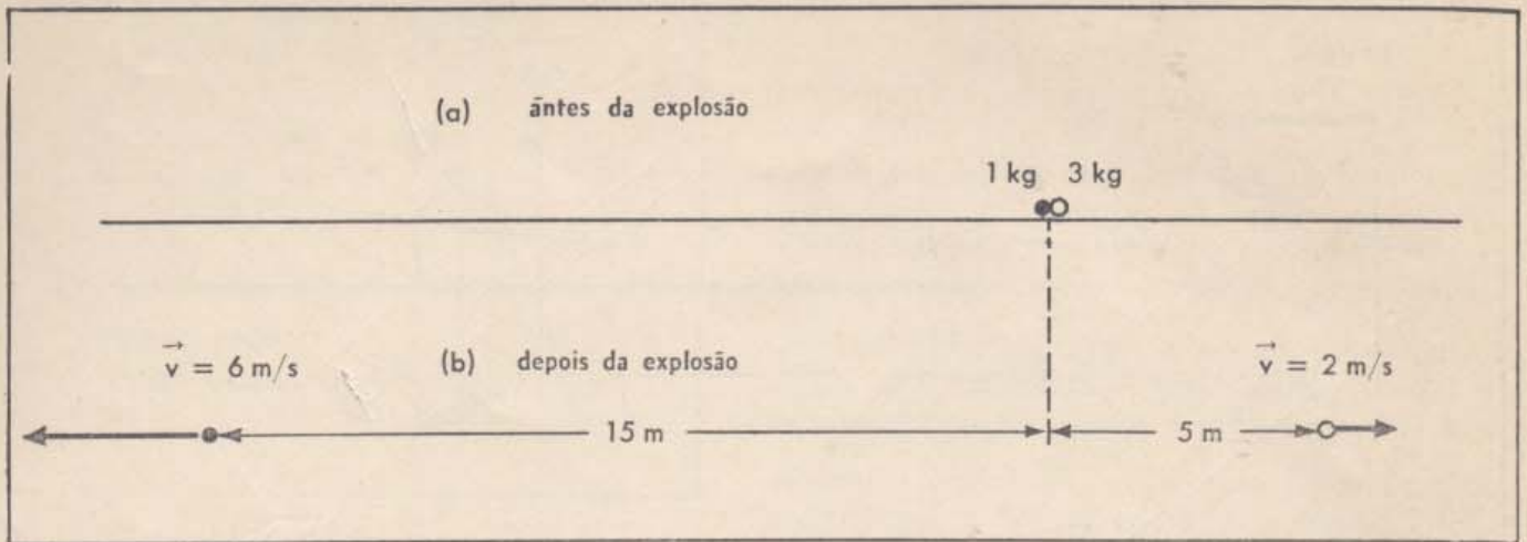
23-17 — Duas massas, uma de 3 kg e a outra de 1 kg, estão numa mesa horizontal sem atrito. Em (a) elas estão ligadas entre si por um cordão e comprimem uma mola. Seu centro de massa coincide com elas. Em (b) o cordão foi queimado e as massas se afastaram — a maior percorreu 5 m e a menor 15 m. Onde está agora o centro da massa?
