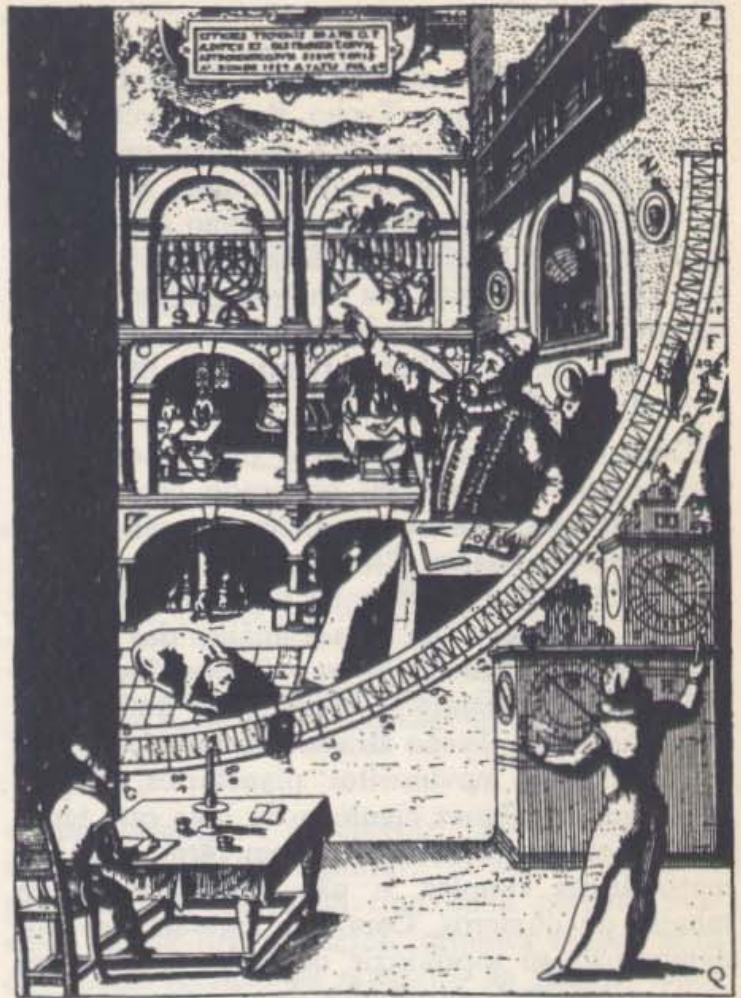
22-7 — (b) Quadrante mural de Tycho Brahe. Um arco de latão de raio superior a 1,8 m foi montado num muro e equipado com visores móveis. Um observador (em cima, à direita) olhava uma estrela por uma janela situada na parede à esquerda. Outros assistentes anotavam o tempo e o ângulo de observação. O setor da parede correspondente ao arco está coberto com uma pintura mural de Tycho e de outros aspectos de seu trabalho.
