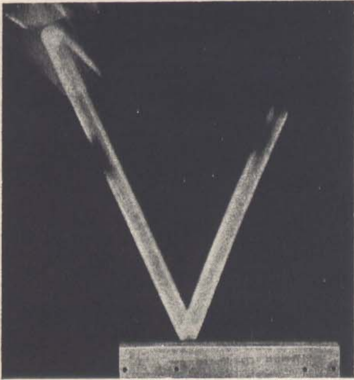
15 - 1. Fotografia de uma bola sendo refletida por uma placa de aço (fotografia com exposição prolongada). O ângulo de reflexão é igual ao ângulo de incidência.
