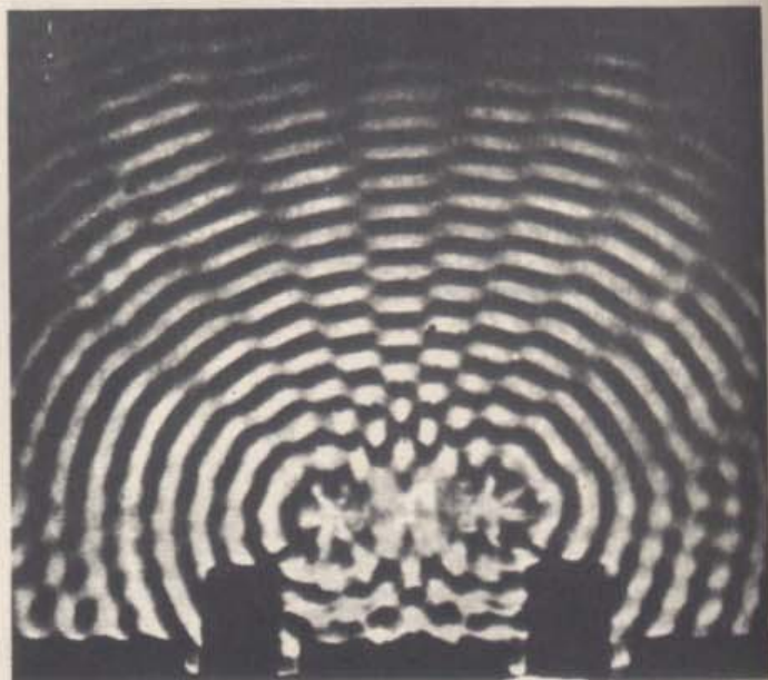
18 — 6. Fotografia da figura de interferência produzida por duas fontes pontuais em fase. Observe as linhas nodais em direção radial.
