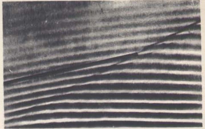
17 — 17. Refração de ondas de alta frequência. As ondas refratadas não são mais paralelas ao marcador preto.
