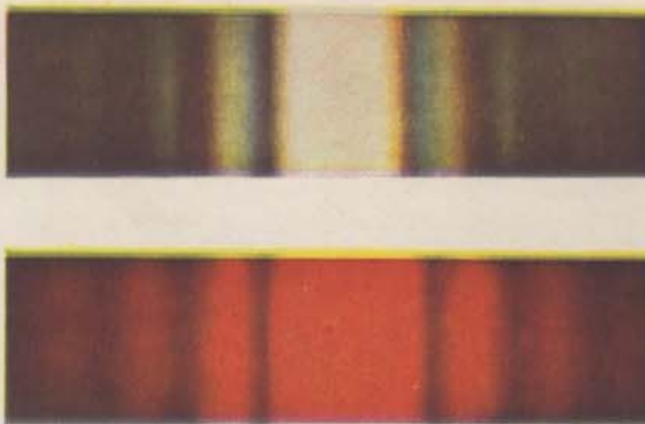
19 - 10. Com o mesmo arranjo utilizado para obter a Fig. 19 - 9, a luz vermelha produziu esta figura. Ambas as figuras são denominadas figuras de difração.
