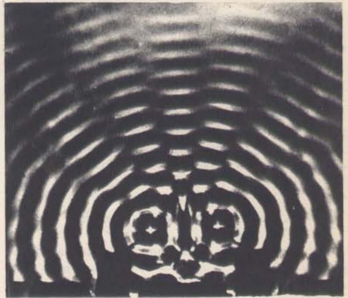
18 — 9. Configuração de interferência de duas fontes, análoga à da Fig. 18 — 6, mas com um maior comprimento de onda.
