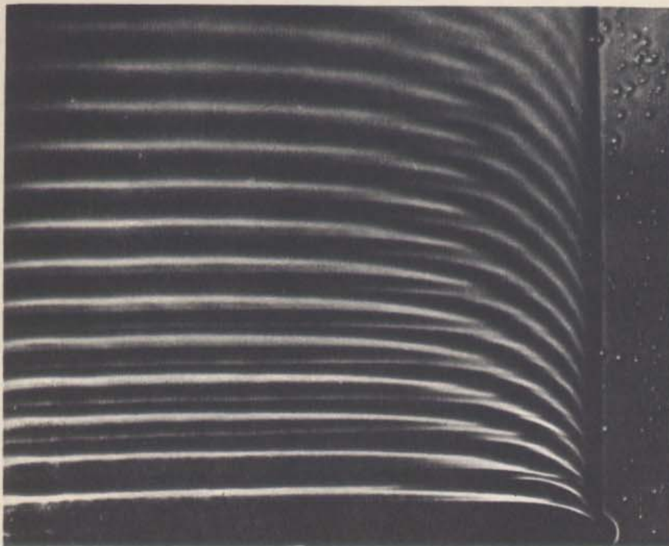
17 - 23. Curvatura de uma onda reta quando a água se torna gradativamente mais rasa de um lado para o outro.
