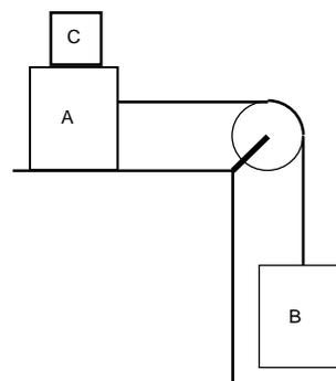
**34)** Um bloco de massa 4,0 kg está sobre uma prancha de 4,0 kg que pode deslizar sobre um assoalho sem atrito, conforme figura abaixo. O coeficiente de atrito entre o bloco e a prancha, tanto estático quanto cinético, é  $\mu = 0,40$ .
