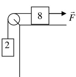
17) No sistema da figura, uma força  $\vec{F}$  atua sobre o bloco de massa 8 kg. Considerando que o sistema está inicialmente parado e usando  $g = 10 \text{ m/s}^2$ , responda às questões:
