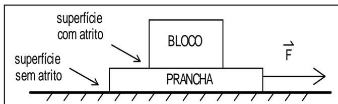
35) Um bloco de massa 10 kg está sobre uma prancha de massa 50 kg, conforme mostra a figura abaixo. O coeficiente de atrito médio entre o bloco e a prancha é  $\mu = 0,2$  e não há atrito entre a prancha e a superfície do solo. Uma força é aplicada sobre o bloco na direção  $30^\circ$  em relação à horizontal e sentido conforme mostra a figura abaixo. Para simplificar o problema, considere que o coeficiente de atrito cinético e o estático sejam iguais.
