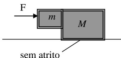
**32)** (HRK P5.9, modificado) Os dois blocos de massas  $m = 16$  kg e  $M = 88$  kg mostrados na figura ao lado estão livres para se mover. O coeficiente de atrito estático entre os blocos é  $\mu_e = 0,4$ , mas a superfície abaixo de  $M$  é lisa, sem atrito. Qual é a força mínima horizontal  $F$  necessária para segurar  $m$  contra  $M$ ?
