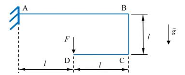
Pede-se determinar os diagramas de esforços solicitantes (N, V e M) para a estrutura dada, em função dos parâmetros fornecidos.
