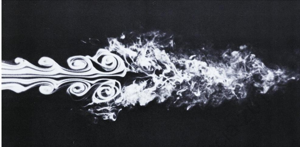
Figura 4.1. Visualização da instabilidade de um jato axissimétrico desenvolvendo-se para um escoamento turbulento. (Fonte: VAN DIKE, 1982)
