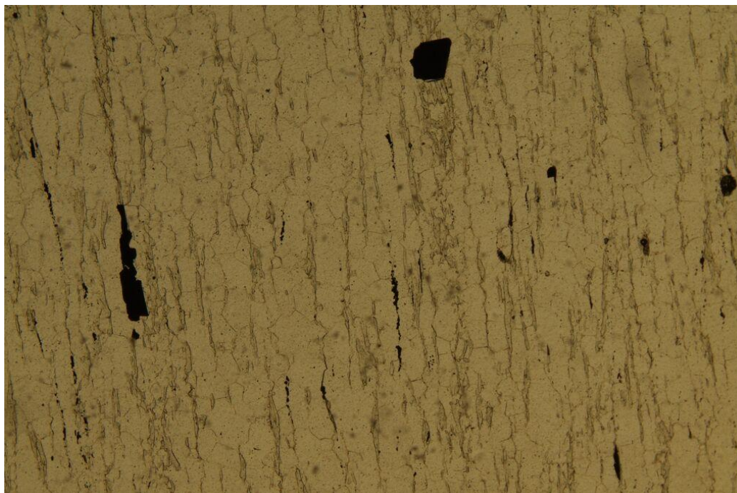
Figura 2: Minerais opacos acompanhando a foliação, Objetiva 4x, sendo que Lado maior = 3.50mm e Lado Menor = 2.70 mm , Câmera Digital Olympus E330
