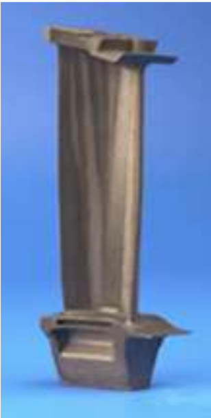
Pá de turbina monocristalina → o canal em forma de espiral permite que apenas um grão cresça na peça
