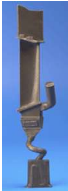
← Pá de turbina para aviões a jato com grãos orientados feita por solidificação direcional
