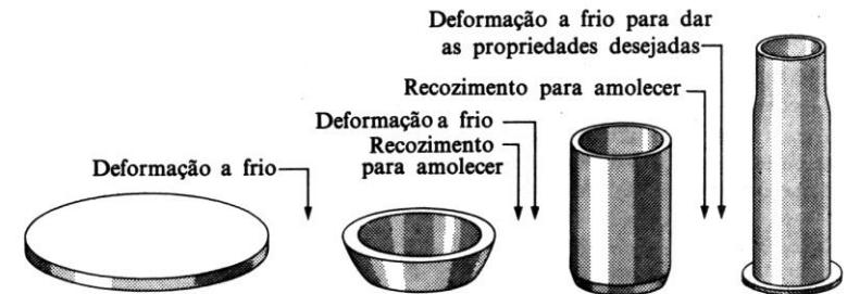
Ciclos de deformação a frio e recozimento (cápsula para cartuchos)
