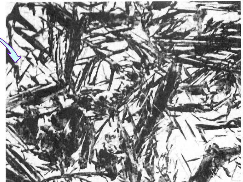
Plaquetas de martensita em um fundo de austenita retida.
