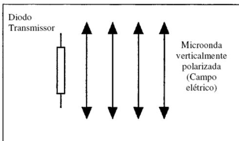
Figura 2 – Polarização Vertical
