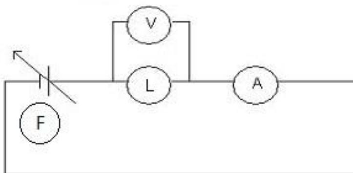
Utilize os dois multímetros para realizar medidas simultâneas da corrente no circuito e da tensão atuando na lâmpada. Leia o texto explicativo sobre o uso do multímetro e o texto sobre incertezas, ajuste de reta, médias, etc., que estão no anexo **Circuitos Elétricos Simples + Multímetros** (disponível na página da disciplina). Siga os seguintes passos:
