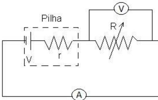
Nesse arranjo **V** representa a tensão da pilha, **r** sua resistência interna (ambos *formam* a pilha) e **R** a resistência (variável) de um reostato. Monte o circuito e utilize um dos multímetros para medir a corrente elétrica. Use o outro multímetro para medir a tensão no reostato.
