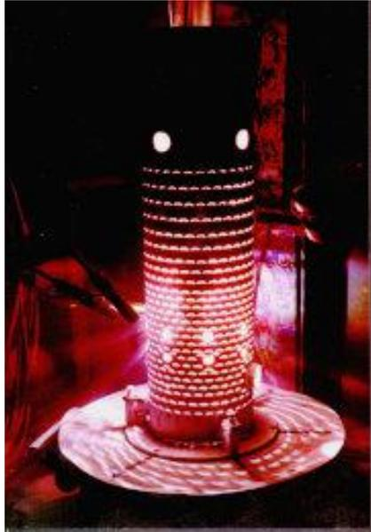
Processo de Revestimento Via Plasma Spray Coating da superfície interna de uma Turbina de Termoelétrica a Gás com Zircônia estabilizada com Ítria.(Plasma & Thermal Coatings Ltd, UK.
