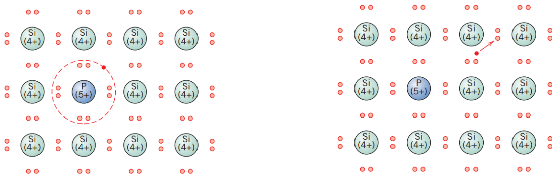
Figura 3b: Condução elétrica em um semiconductor extrínseco do tipo-n
