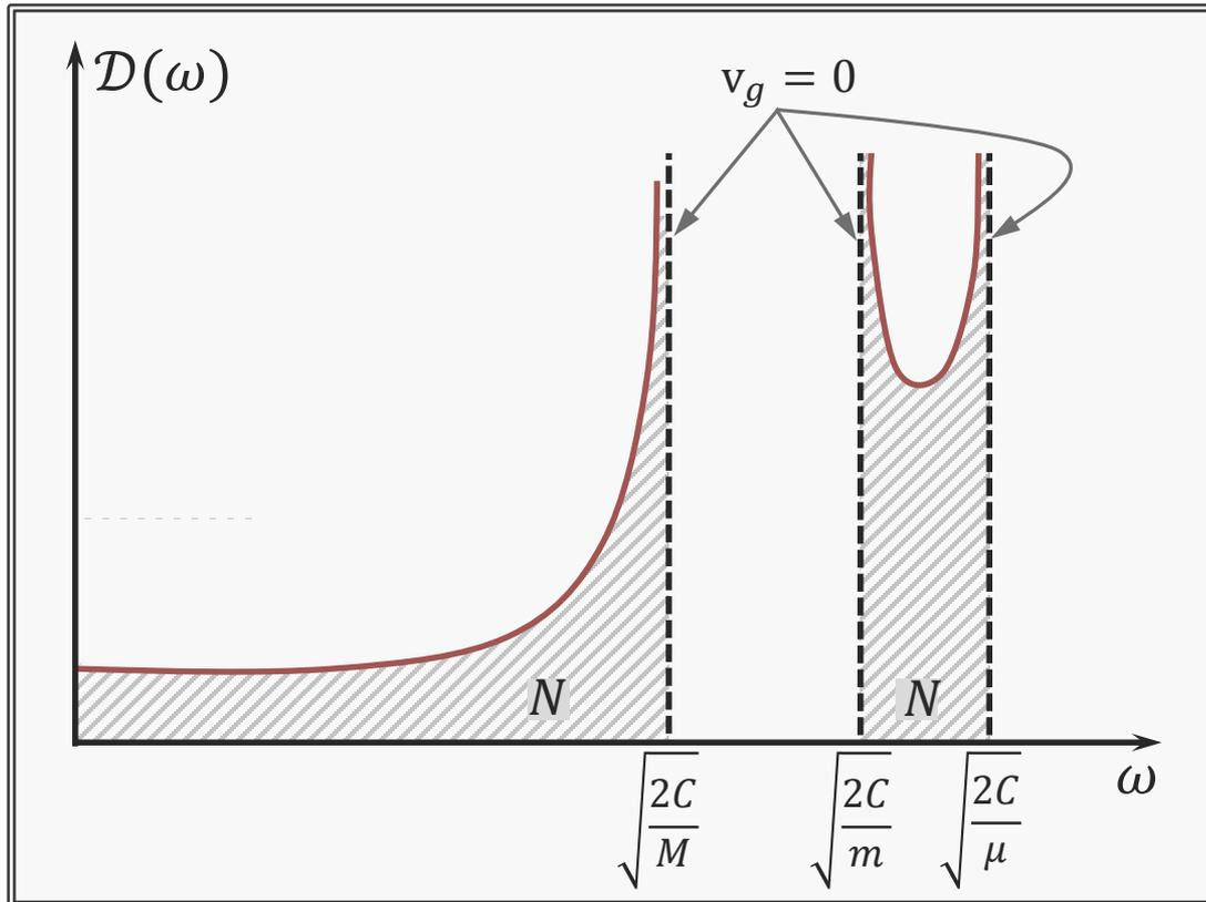
$$\mathcal{D}(\omega) = \mathcal{D}_{\text{acústico}}(\omega) + \mathcal{D}_{\text{óptico}}(\omega)$$
