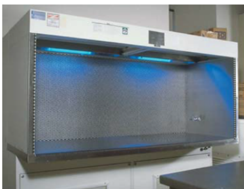
Figura 5.34 Fluxo laminar de segurança biológica. Uma fonte de luz ultravioleta (UV) é utilizada para evitar a contaminação da cabine quando não está em uso. Quando a cabine está em uso, o ar externo à câmara é bombeado através do filtro HEPA. O ar presente no interior da câmara é deslocado através das ventilações que circundam a face anterior e retorna através do filtro HEPA. Assim, a câmara é desenvolvida de modo a propiciar uma área de trabalho livre de contaminantes para manipulação de microrganismos e culturas de tecidos.
