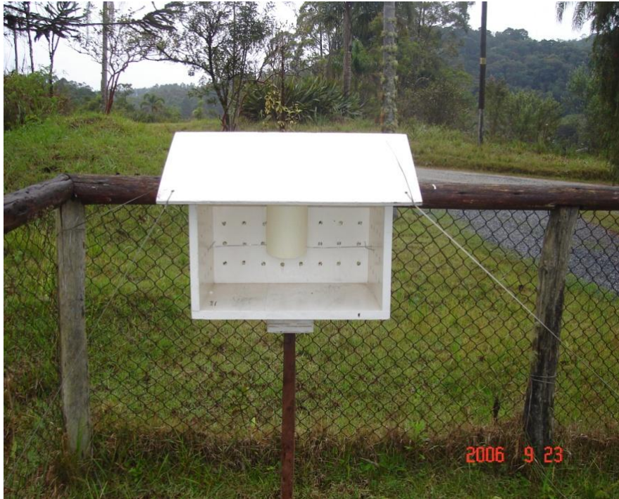
Mini-abrigo com sensor de temperatura e umidade relativa do ar.
