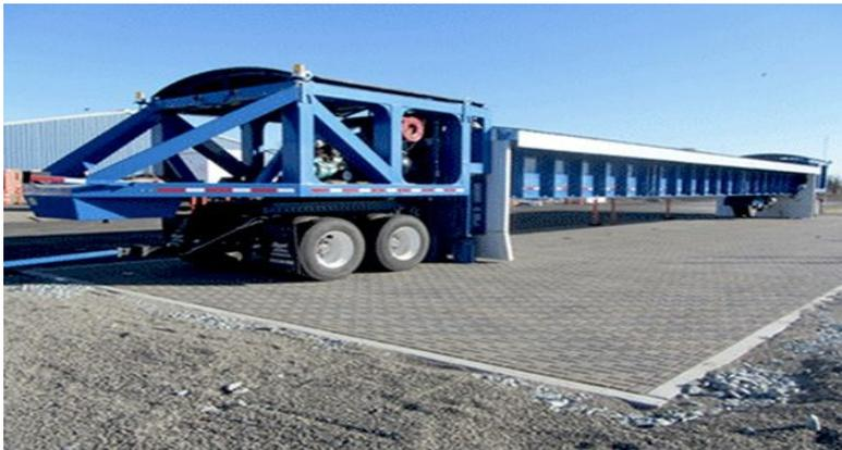
**Figura 2.2-** Simulador Linear HVS
