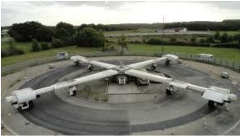
**Figura 2.1-** Simulador Manège de fadigue de campo fechado
